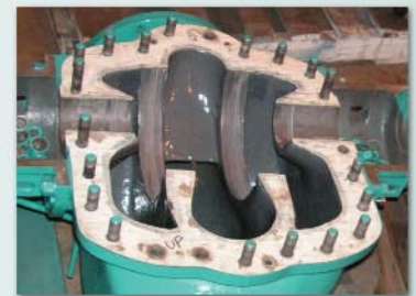
A teljesen megtisztított elhasználódott felület
